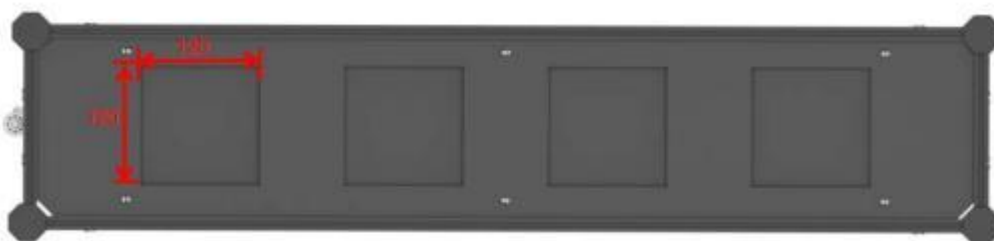
图 2.2-11 凹槽示意图（俯视图）
