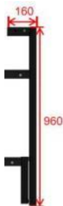
图 2.2-18 旗帜悬挂尺寸图（正视图）
